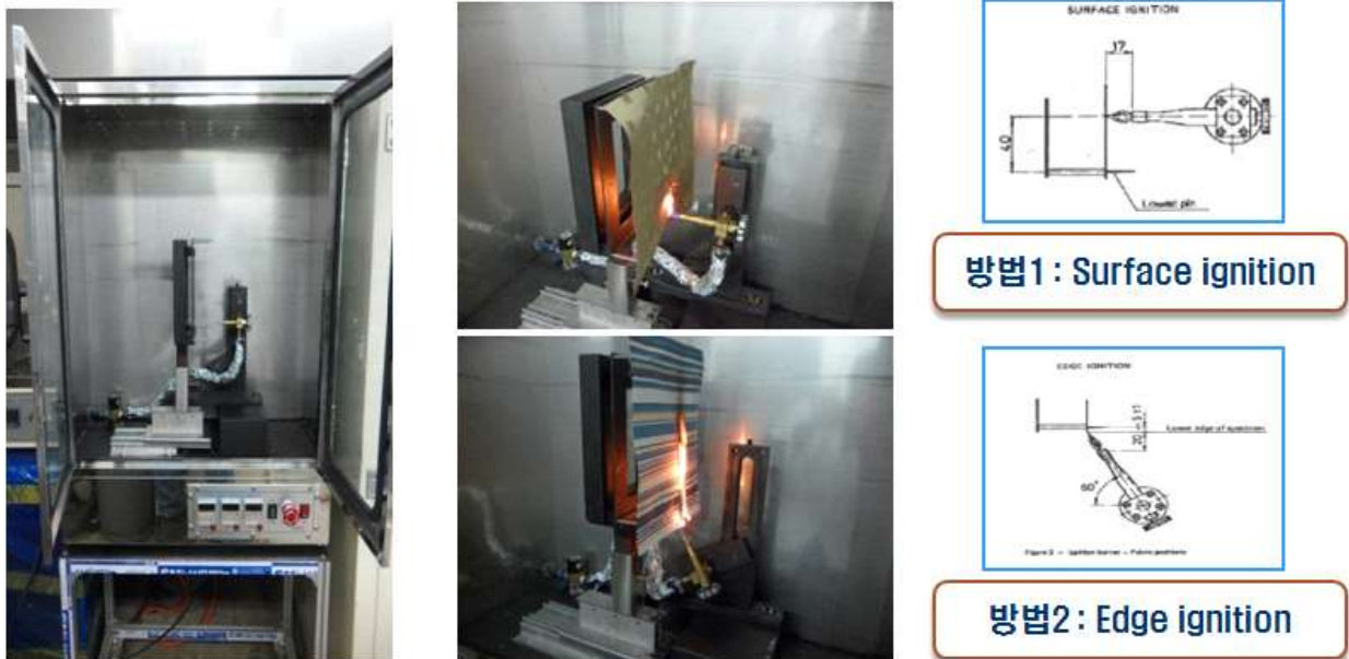
그림 9. Drapery/Wall covering용 IMO 난연시험
