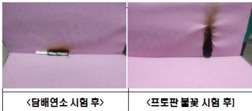
그림 11. 가구류용 IMO 난연시험
