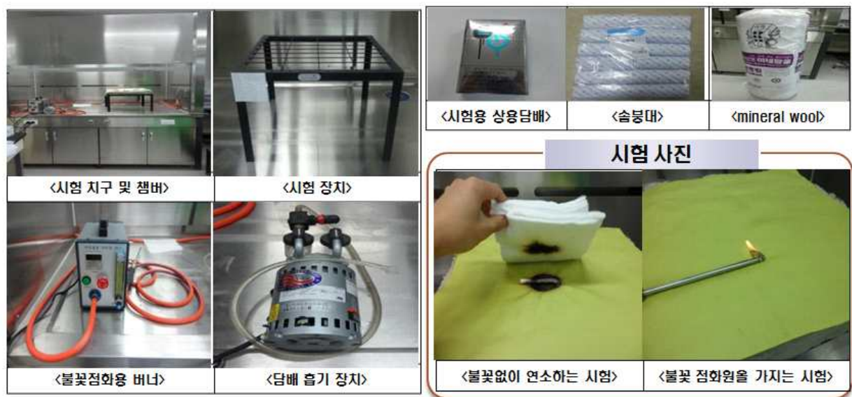
그림 10. 침구류용 IMO 난연시험
