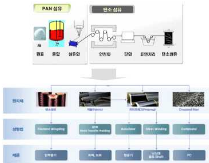
그림 4. PAN계 탄소섬유(Carbon Fiber)의 제조공정
